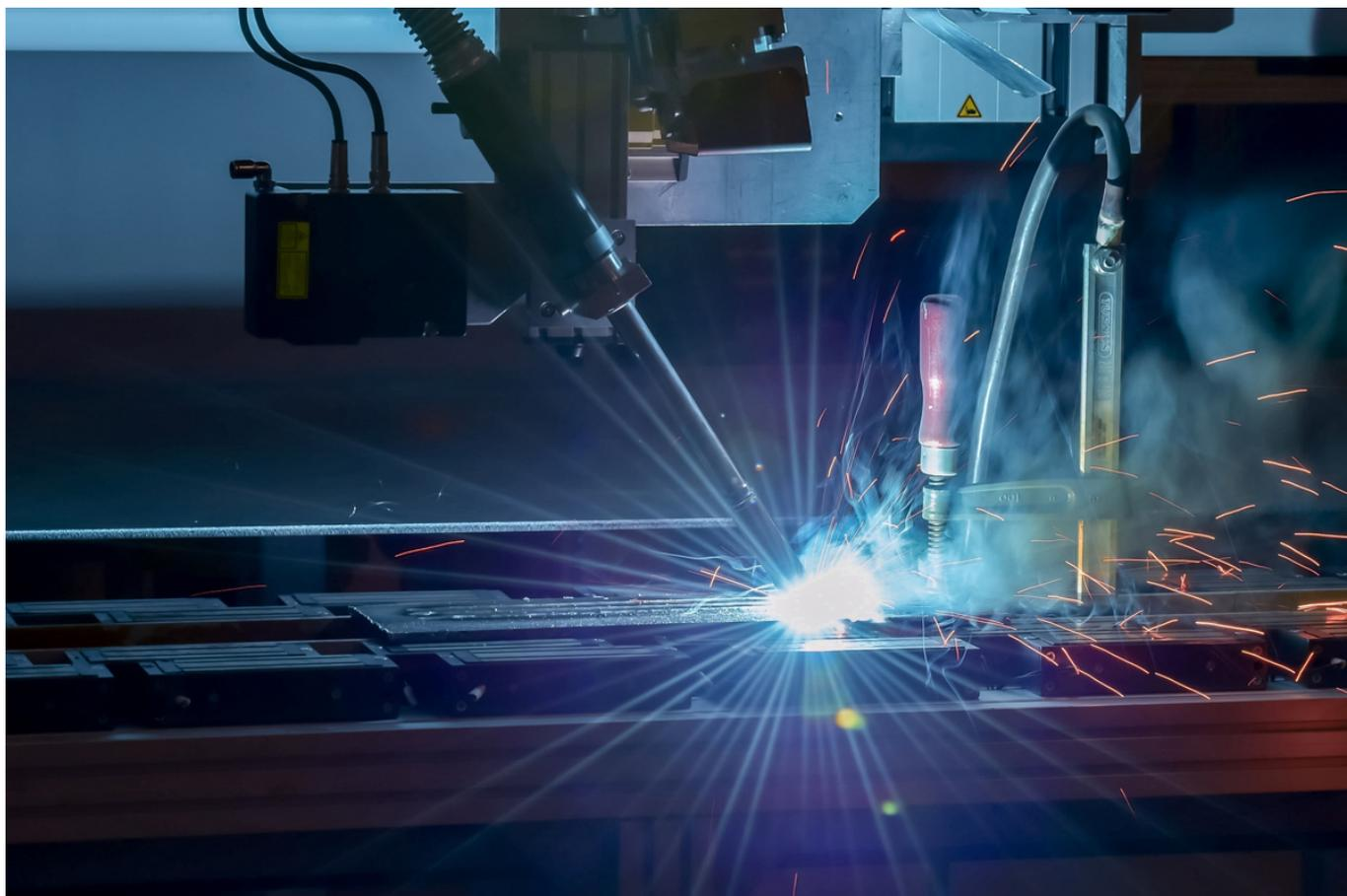
В разработанной технологии для печати используется промышленный робот. Для изготовления изделий больших размеров ученые Политеха разработали специальное программное обеспечение. В программе, по заданной 3D-модели изделия, строится цифровая модель передвижения робота при печати (САМ-модель), при этом деталь разбивается на слои, затем в каждом из слоев задается траектория движения. Таким образом, строится часть цифрового двойника изделия.
