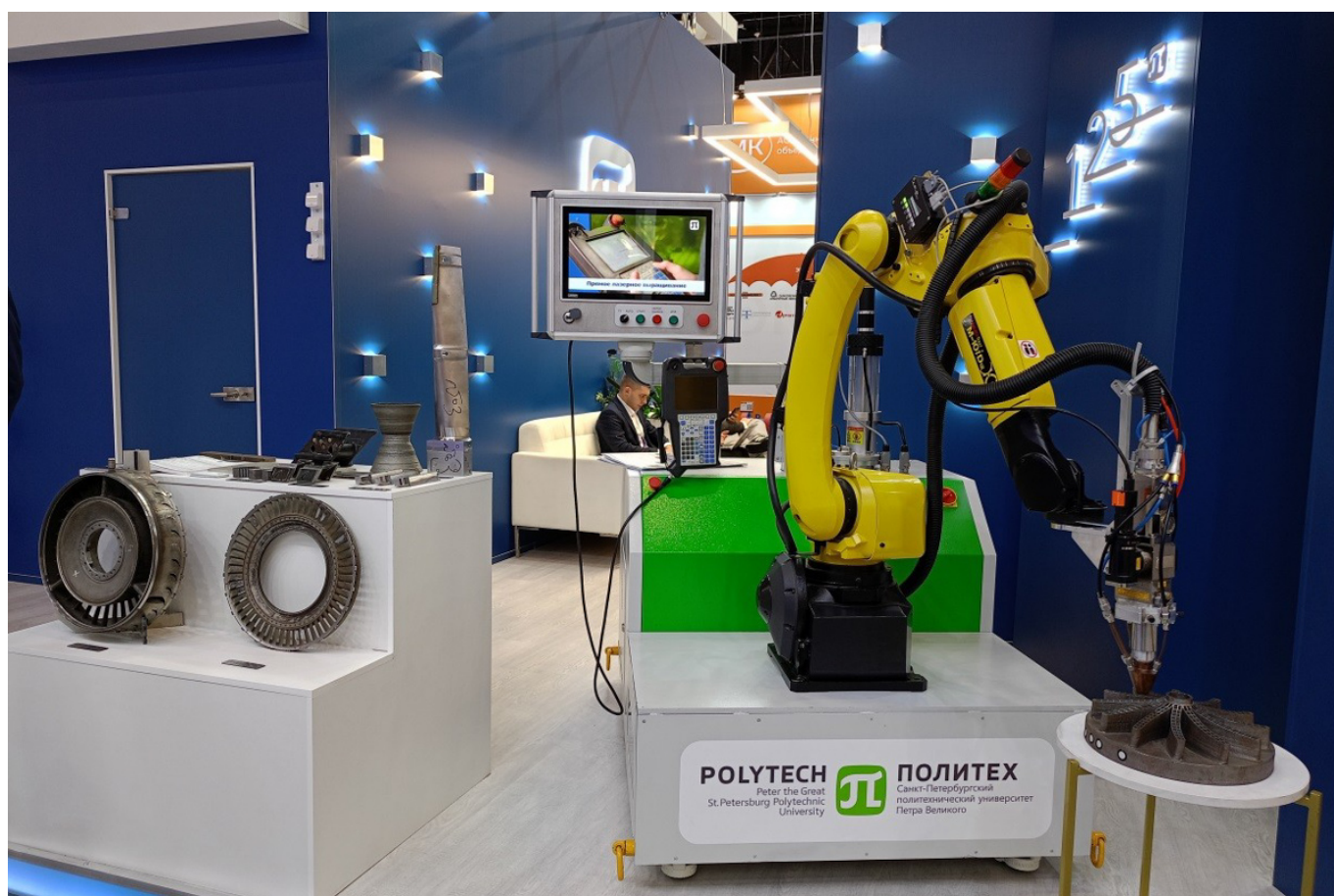
Разработка мобильного комплекса лазерной наплавки «Кочевник»
