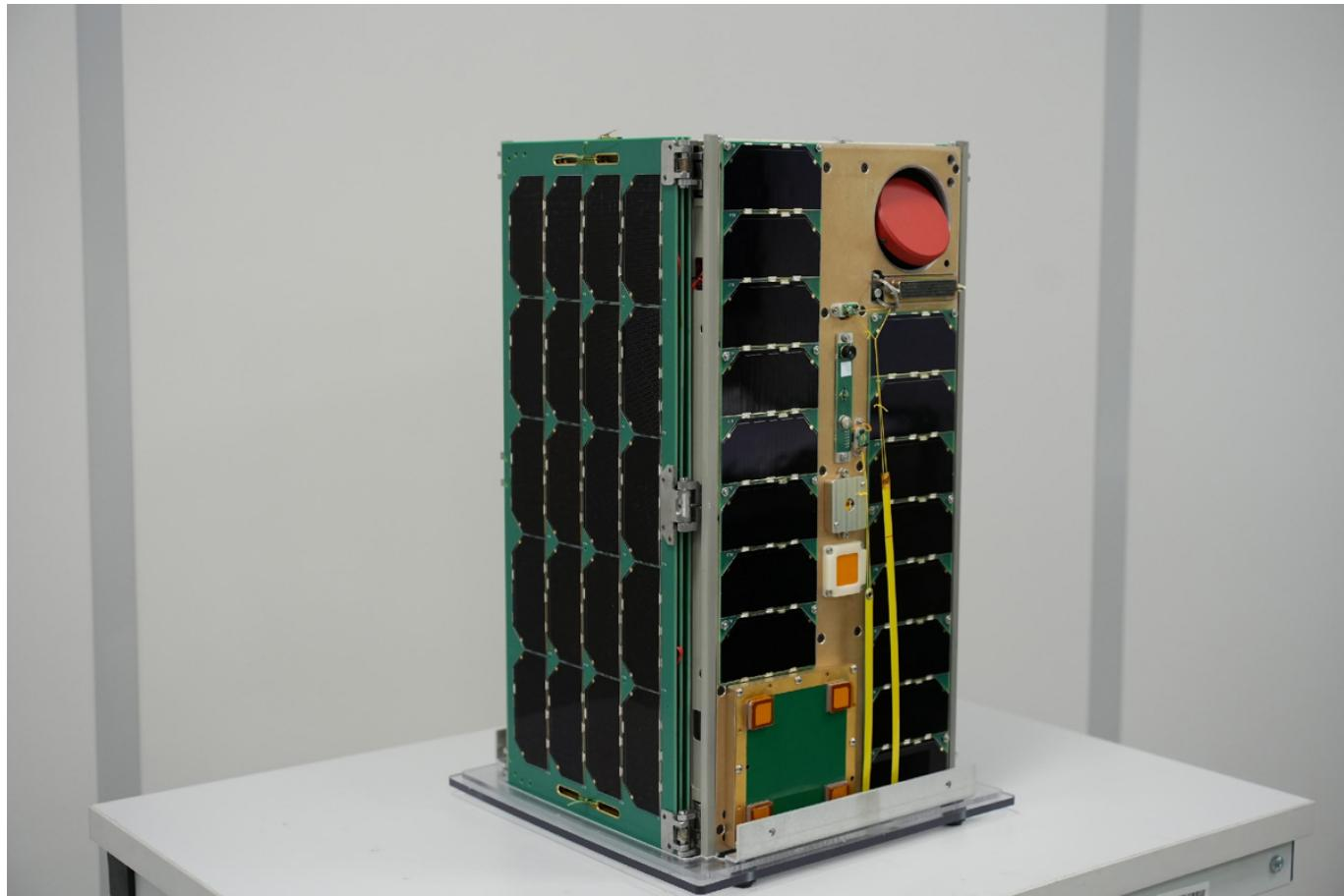
— Также на спутнике установлена новая версия бортового приёмника АИС с низким энергопотреблением, позволяющим ему работать в режиме 24/7. А экспериментальная аппаратура межспутниковой связи может повысить оперативность обработки полезных данных на борту и снизить объём передаваемых на наземный пункт управления данных полезной нагрузки космического аппарата, — рассказал старший научный сотрудник Высшей школы прикладной физики и космических технологий ИЭиТ СПбПУ Сергей Волвенко.
